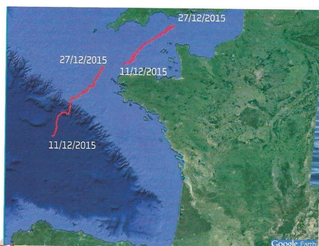
3 Trajectoires de deux bouées dérivantes, au large de la Bretagne. Ces bouées, qui se déplacent en suivant les courants marins, sont équipées de plusieurs appareils pour mesurer la température de l'eau et la vitesse du vent.
