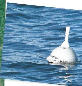
3 Trajectoires de deux bouées dérivantes, au large de la Bretagne. Ces bouées, qui se déplacent en suivant les courants marins, sont équipées de plusieurs appareils pour mesurer la température de l'eau et la vitesse du vent.
