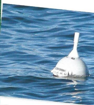
3 Trajectoires de deux bouées dérivantes, au large de la Bretagne. Ces bouées, qui se déplacent en suivant les courants marins, sont équipées de plusieurs appareils pour mesurer la température de l'eau et la vitesse du vent.
